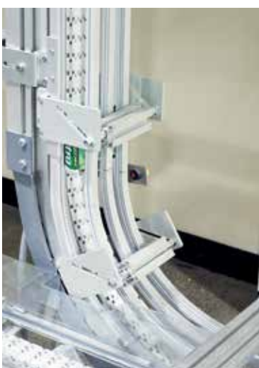
Rampas de gravedad
